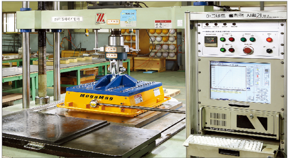
▲ 컴퓨터가 장착된 50톤 흡착력 시험기. 모든 생산제품들은 전수 흡착력을 시험하며, 제조번호만으로 검사기록 확인이 가능하다.
