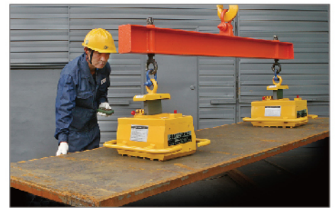
▲ 마그리프트 2대를 리프트빔을 이용해 안전 확보
