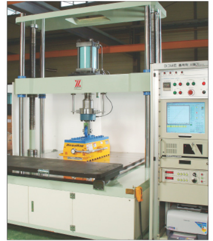
▲ 컴퓨터가 장착된 50톤 흡착력 시험기기. 모든 생산 제품들은 전수 흡착력을 시험하며, 제조번호만으로 검사기록 확인이 가능하다.
