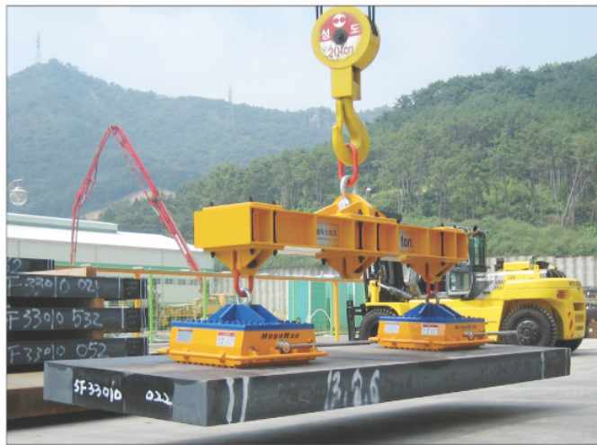
▲ MGM-10000(정격 사용 용량 10톤) 두 대로 14톤 (철판 가로 5,000×세로 1,400×두께 250mm)의 운반물을 흡착한다.
